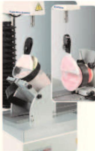
Предыдущая конструкция насадки для оценки силы адгезии была значительно улучшена; данная модель подходит для оценки качества и силы запаивания контейнера, и адгезии клейких лент.
