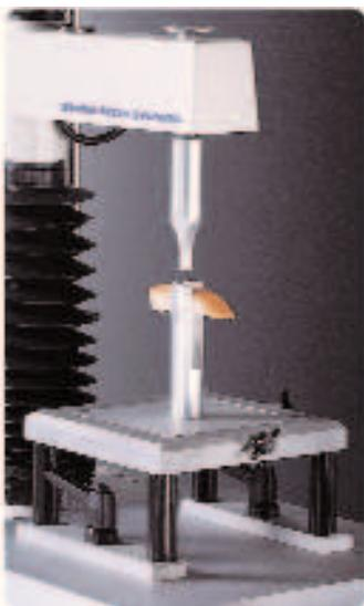
Это приспособление имитирует надкусывание пищи резцами. Состоит из верхней и нижней браншей, закрепляющихся на тензодатчике и основной платформе. Образец размещается на нижней бранше, а верхняя опускается, имитируя сдвигающие силы при надкусывании.
