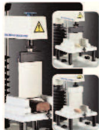
Набор лезвий HDP/BS включает: лезвие Уорнер Братцлер, обратное лезвие, вставка с прорезью для лезвий. Обратное лезвие имеет изогнутый режущий край на одном конце и прямой край («гильотина») на другом.
