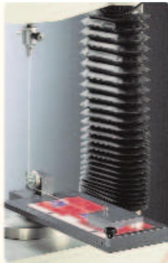
Используется для определения статического и динамического коэффициента трения пластиковых пленок и упаковочных материалов. Соответствует требованиям ASTM D 1894-90. Может использоваться для определения характеристик трения материалов, скользящих по таким же или другим материалам в соответствующих условиях испытания.
