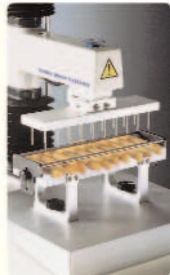
Предназначена для измерения силы проникновения зонда в несколько образцов чипсов одновременно. Она позволяет исследовать до 10 чипсов одновременно, при этом гарантируется полное проникновение зонда диаметром 2 мм.
