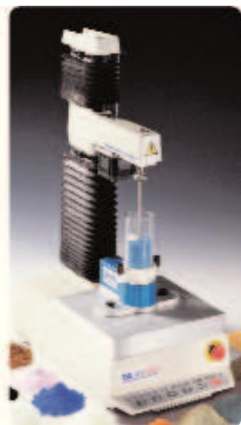
Однако пользователь может также полностью запрограммировать прибор для выполнения циклов разрезания на ломтики, сжатия, уплотнения и аэрации в любом сочетании.
