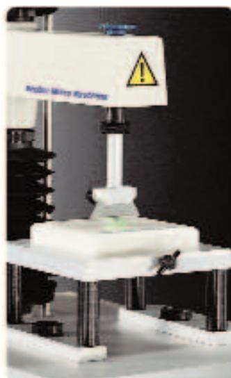
Включает стандартное заменя-емое лезвие шириной 50 мм, позво-ляющее точно разрезать образцы. Острое лезвие может резать твер-дые продукты; есть также вариан-т «сменного» лезвия, если оно затупи-лось.
