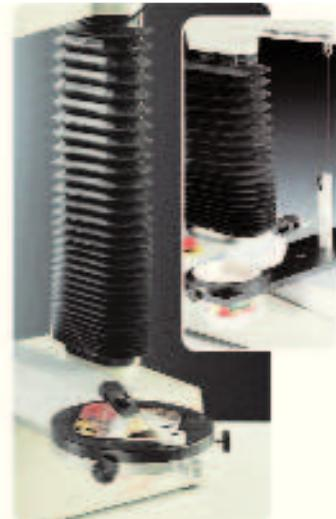
Предназначены для испытания на силу отрыва запаянных крышек баночек с кремом, йогуртом и подобными продуктами под углом.
