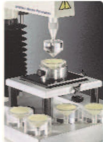
Предназначена для измерения способности продукта, например, маргарина или столового масла, распределяться тонким равномерным слоем. Она состоит из конуса 90° с охватываемым соединением и пяти точно соответствующих ему держателям конической формы с охватываемым соединением.
