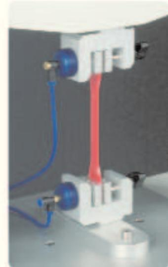
Пневматические зажимы чаще оказываются предпочтительнее для испытаний на растяжение, так как позволяют точно контролировать давление при захвате и на него не влияет деформация образца. Такой тип зажима имеет рычаги, приводящиеся в действие баллонами со сжатым воздухом, встроенными в корпус.
