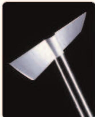
Это точный и достоверный способ измерения характеристик сыпучести порошков. Быстро устанавливается на анализатор текстуры, что позволяет производителю оценить и избежать типичных проблем, например, непостоянство состава компонентов в партии и сырье, склеивание во время хранения и перевозки, а также сложности при высыпании из бункеров или бочек.
