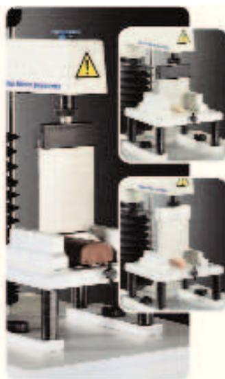
Набор лезвий HDP/BS включает: лезвие Уорнер Братцлер, оборотное лезвие, вставка с прорезью для лезвий. Оборотное лезвие имеет изогнутый режущий край на одном конце и прямой край («гильотина») на другом.
