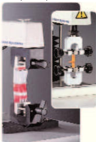
Зажимы A/TG закрепляются винтом, при закручивании которого сдвигаются их рифленые бранши. Это зажимы общего назначения, подходящие для удерживания образцов с равномерной прямоугольной формой и максимальной толщиной 25 мм.
