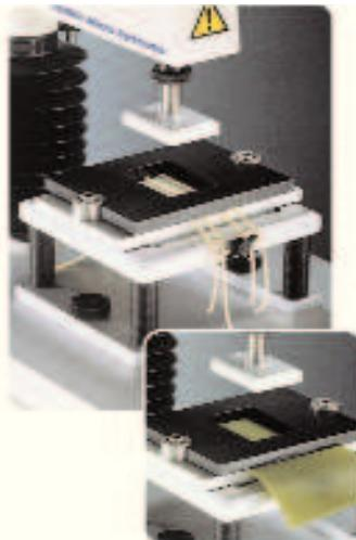
Используется для измерения твердости и слипаемости варенных макаронных изделий. Полоски или листы теста удерживаются с помощью поддерживающего блока с прямоугольной секцией с отверстием.
