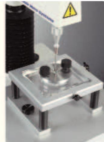
Выпускается в двух вариантах. Насадка с большим зазором подходит для методик, требующих приложения значительной силы, когда размеры штампа/пробойника критичны. Устройство выравнивается автоматически с помощью универсального переходника. Насадка с маленьким зазором подходит для разных типов исследований со сжатием порошков, например, оценки ломкости гранул, где размеры штампа/пробойника менее критичны.
