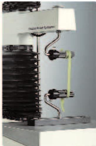
Идеально подходит для измерения прочности на разрыв и эластичности образцов лапши и спагетти. Образец вставляется через щели в параллельных валиках, и его концы закручиваются на 2-3 оборота для уменьшения скольжения и для закрепления.
