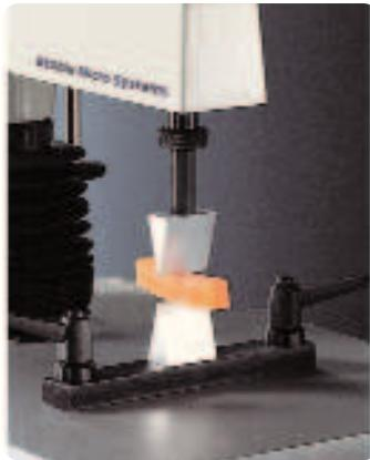
Это устройство состоит из нижнего и верхнего клиньев с углом заточки 30° и шириной 30 мм. Нижний клин закрепляется непосредственно на основании анализатора текстуры, а верхний – на тензодатчике.
