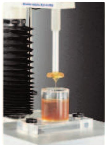
Включает контейнер для образца, расположенный в центре под поршнем. Поршень сдавливает образец, который выталкивается вверх вдоль краев диска.
