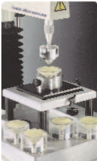
Предназначена для измерения способности продукта, например, маргарина или столового масла, распределяться тонким равномерным слоем. Она состоит из конуса 90° с охватываемым соединением и пяти точно соответствующих ему держателей конической формы с охватываемым соединением.
