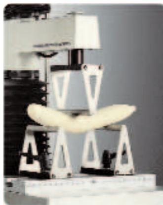
Большая часть состоит из основания с градированной опорой регулируемой длины (до 240 мм) и позволяет исследовать образцы шириной до 90 мм.
