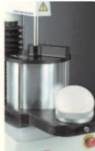
Система для раздувания теста DR/DIS2 предназначена для измерения реологических свойств при растяжении в условиях напряжений, сходных с таковыми при увеличении объема изделий во время выпечки, и позволяет определять реологические свойства теста и клейковины при растяжении по двум осям.
