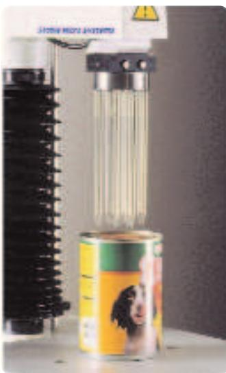
Предназначен для определения прочности и твердости таких продуктов, как: корма для животных или эмульсии, – содержащих крупные частицы. Такие продукты сложны для измерения из-за неравномерного распределения частиц по числу, раз-меру и форме в каждом контейнере.
