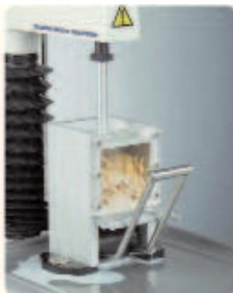
Это основа испытательной системы Оттава (OTMS), и состоит из квадратной ячейки для образца и неплотно прилегающего поршня.
