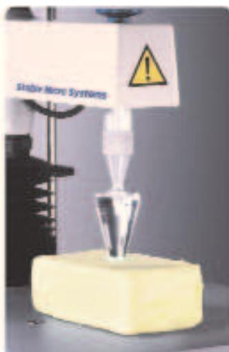
Мы предлагаем четыре вида зондов из перспекса с углами от 30° до 60° для испытания с погружением конуса таких продуктов, как: масло, маргарин и прочие продукты с пластическими свойствами. Конусная пенетрометрия хорошо коррелирует с органолептической оценкой и результатами определения растекаемости.
