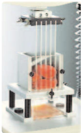
Имеются две версии ячейки Крамера для определения силы сдвига. С тензодатчиком 50 кг или более нужно использовать HDP/KS10 с 10 лезвиями. HDP/KS5 с 5 лезвиями может использоваться с тензодатчиками 25 или 30 кг для мягких продуктов, но рекомендуется тензодатчик 50 кг или более.
