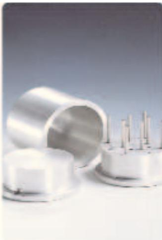
Эта насадка используется для определения характеристик бисквитного теста. Комплект состоит из испытательной ячейки, поршня для удаления воздуха и поршня для уплотнения. Образец помещается в ячейку, распределенные в нем воздушные карманы удаляются с помощью поршня с зубцами, а затем поверхность выравнивается поршнем для уплотнения.
