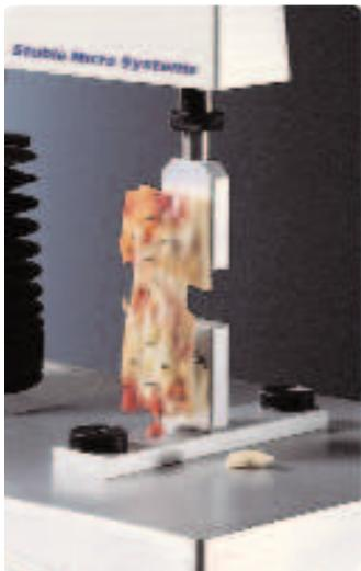
Эта насадка состоит из двух компонентов с четырьмя штырьками. Верхний компонент присоединяется непосредственно к тензодатчику, а нижний – к основанию анализатора текстуры. Исследуемый образец прямоугольной формы закрепляется с помощью штырей. Измеряется сила растяжения и разрыва образца, являющиеся показателями жесткости пиццы.
