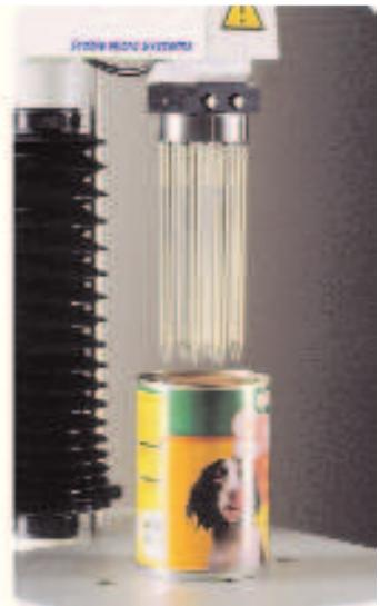
Предназначен для определения прочности и твердости таких продуктов, как корма для животных или эмульсии, содержащих крупные частицы. Такие продукты сложны для измерения из-за неравномерного распределения частиц по числу, размеру и форме в каждом контейнере.
