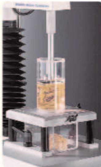
Предназначена для измерения силы сжатия, которую необходимо приложить к поршню для экструзии продукта через выходное отверстие стандартного размера в основании контейнера для образца. Контейнер для образца может вмещать диски с диаметром 3, 5, 7 или 10 мм, их выбор зависит от консистенции образца.
