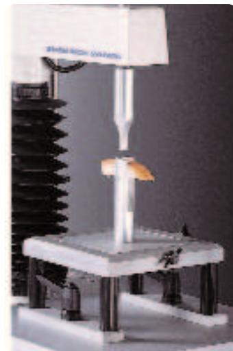
Это приспособление имитирует надкусывание пищи резцами. Состоит из верхней и нижней браншей, закрепляющихся на тензодатчике и основной платформе. Образец размещается на нижней бранше, а верхняя опускается, имитируя сдвигающие силы при надкусывании.
