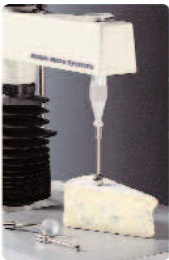
Мы предлагаем сферические (шарообразные) зонды диаметром 0.25"-1.0" (6.25-25.4 мм) и один тип полусферических зондов. Они применяются для измерения хрупкости чипсов и других закусок. Кроме того, их можно использовать для определения твердости поверхности фруктов, сыра и упаковочных материалов методом вдавливания; часто этот метод предпочтительнее испытания на прокол, особенно если у образца неровная поверхность.
