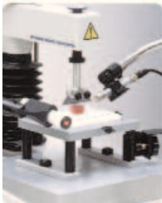
Позволяет измерять высвобождение звуковой энергии во время физического испытания. Измеряется испускание звуковых волн в диапазоне до 12 кГц и переводится в аналоговое напряжение, которое соответствует количеству высвобожденной звуковой энергии из продукта как функции времени.
