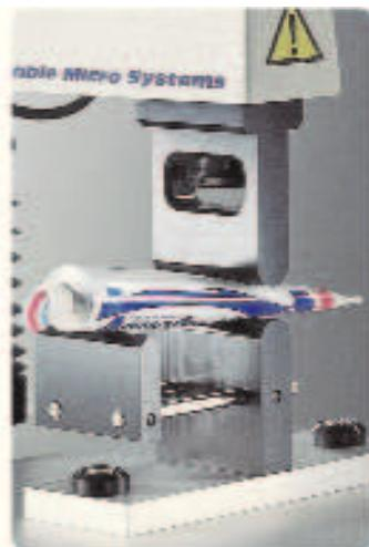
При производстве зубной пасты важны три характеристики – отсутствие комков или зернистости, отсутствие пузырьков воздуха и нужная консистенция. На все эти качества сильно влияет процесс производства, контроль и выбор сырья.
