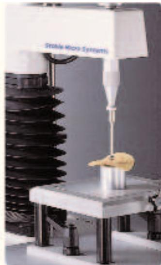
Используется для измерения ломкости закусок и картофельных чипсов с помощью зонда для испытания на проникновение. Позволяет быстро и точно расположить образец и используется в сочетании с платформой повышенной прочности.
