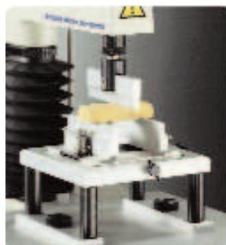
Большая часть состоит из основания с градуированной опорой регулируемой длины (до 240 мм) и позволяет исследовать образцы шириной до 90 мм. Меньшая часть с тремя точками перегиба представляет собой опору регулируемой длины до 70 мм и вмещает образцы шириной до 80 мм.
