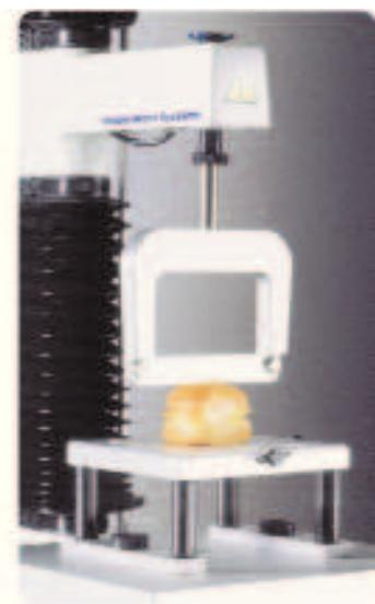
Это устройство включает сменное лезвие толщиной 0,9 мм, вставляющееся в раму шириной 115 мм. Оно было введено в связи с популярностью стандартного ножа для резьбы и необходимостью в тонком ноже для резки более толстых и широких фрагментов. Максимальная ширина образца 100 мм.
