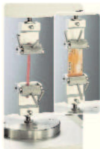
Пружинные ролики с попечными штрихами образуют самозатягивающийся механизм, удерживающий образцы шириной до 45 мм и длиной до 10 мм. Эти зажимы идеальны для измерения прочности на разрыв и особенностей разрыва разнообразных материалов с гладкой поверхностью или изменяющих свои физические свойства после растяжения.
