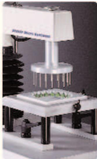
Позволяет измерять силу проникновения зонда в несколько (до 18) образцов одновременно. Вставка имеет 18 углублений, расположенных вокруг конуса, что позволяет легко расположить образцы в необходимых для испытания положениях. Затем измеряется сила прокола и проникновения, а глубина проникновения устанавливается так, чтобы зонды прокололи образец на всю его толщину.
