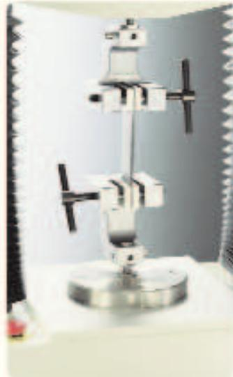
A/HDT – зажимы для испытания растяжимости с максимальной нагрузкой 500 кг (5 кН). Поверхности зажима имеют ширину 50 и высоту 30 мм; они рифленые. По специальному заказу возможна поставка зажимов с другой поверхностью. Зажимы могут удерживать образцы максимальной шириной до 12 мм.
