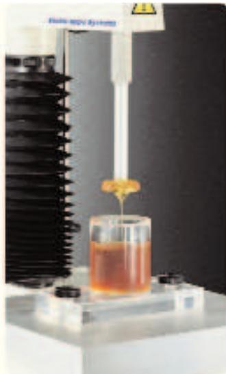
Включает контейнер для образца, расположенный в центре под поршнем. Поршень сдавливает образец, который выталкивается вверх вдоль краев диска.
