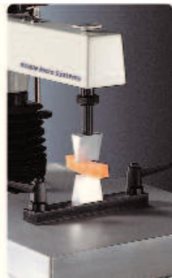
Это устройство состоит из нижнего и верхнего клиньев с углом заточки 30° и шириной 30 мм. Нижний клин закрепляется непосредственно на основании анализатора текстуры, а верхний – на тензодатчике.
