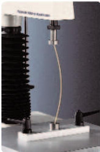
Предназначена для измерения характеристик сжатия и изгиба сырых макаронных изделий при исследовании на возможную ломкость в результате порчи зерна вследствие прорастания или неправильной сушки.
