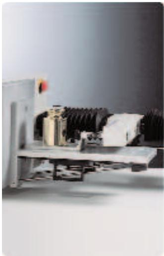
Состоит из несущей и регулируемой по высоте ножек, которые закрепляются на анализаторе текстуры так, чтобы вся конструкция могла располагаться горизонтально.
