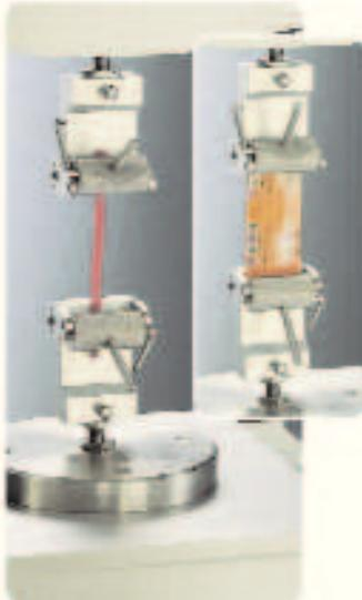
Пружинные ролики с попечными штрихами образуют самозатягивающийся механизм, удерживающий образцы шириной до 45 мм и длиной до 10 мм. Эти зажимы идеальны для измерения прочности на разрыв и особенностей разрыва разнообразных материалов с гладкой поверхностью или изменяющихся свои физические свойства после растяжения.
