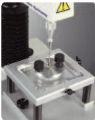
Это устройство позволяет измерять прочность на разрыв тонких изделий в форме пленки, например: полоски для освежения дыхания, нории, листовой желатин, вафли или рисовая бумага. Все это должно быть достаточно прочным, чтобы не ломаться в руках потребителя. Насадка с держателем для пленок позволяет выявить пониженную прочность и соответствующим образом скорректировать состав.
