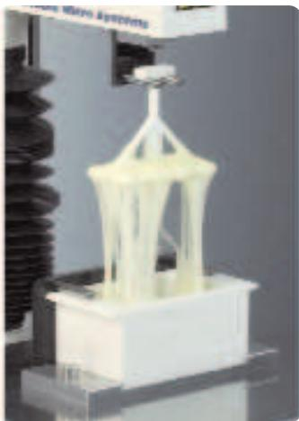
Состоит из сосуда для микроволновой обработки и двухстороннего вильчатого зонда. В систему с сосудом и вилкой помещают образец сыра известной массы и обрабатывают микроволновым излучением до расплавления сыра. В сосуд помещается фиксирующая вставка, и система сосуда/вилки устанавливается на основание, надежно закрепленное на анализаторе текстуры. Вилка подсоединяется к тензодатчику с помощью быстроразъемного переходника.
