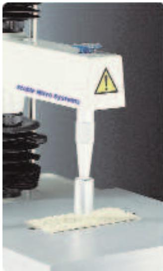
Семейство зондов с уплощенным концом диаметром от 2 до 50 мм подходит для исследования самых разнообразных образцов.
