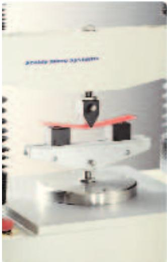
Исследуемый образец прямоугольного или круглого сечения укладывается на две опоры с известным расстоянием между ними. Затем на точку, равноудаленную от обеих опор, воздействует изгибающая сила на постоянной скорости, либо до определенного значения силы, либо до разлома образца.
