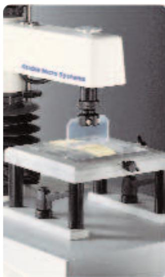
Небольшое лезвие из перспекса, располагающееся непосредственно на тензодатчике, используется для исследования образцов малого размера, для разламывания или разрезания которых не требуется большого усилия.
