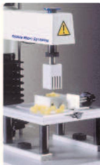
Миниатюрная ячейка особенно хорошо подходит для уменьшения силы сдвига/сжатия продуктов, состоящих из отдельных частиц, или неоднородной структуры. Присоединяется к основной платформе HDP/90. В зависимости от того, какое испытание требуется – измерение силы сдвига или сжатия/экструзии, – к кронштейну анализатора текстуры можно присоединить головку с 5 лезвиями или пресс.
