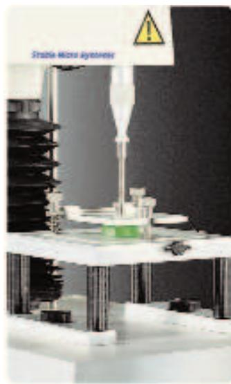
При исследовании слипаемости таких продуктов, как кондитерские изделия, их необходимо зафиксировать, в противном случае образец останется на зонде при попытке его извлечения.
