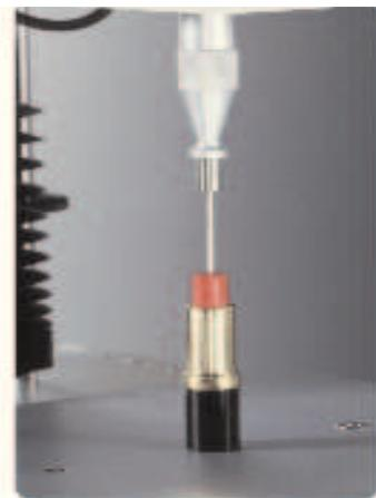
Твердость губной помады – важный параметр, описанный в стандартном методе испытания ASTM D1321-95, где описано применение испытания на глубину проникновения иглы.
