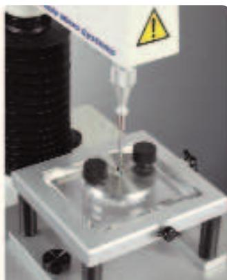
Это устройство позволяет измерять прочность на разрыв тонких изделий в форме пленки, например: полоски для освежения дыхания, нории, листовой желатин, вафли или рисовая бумага. Все это должно быть достаточно прочным, чтобы не ломаться в руках потребителя. Насадка с держателем для пленок позволяет выявить пониженную прочность и соответствующим образом скорректировать состав.
