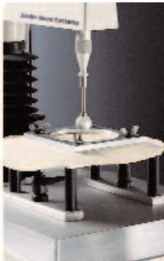
Разработана для измерения растяжимости и эластичности теста для слоенных кондитерских изделий и лепешек. Кроме того, позволяет быстро и надежно закреплять различные типы тонких или слоистых образцов.
