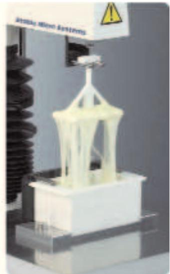
Состоит из сосуда для микроволновой обработки и двухстороннего вильчатого зонда. В систему с сосудом и вилкой помещают образец сыра известной массы и обрабатывают микроволновым излучением до расплавления сыра.
