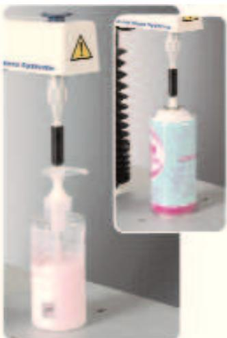
Этот тест позволяет изменить силу, необходимую для нанесения средств для укладки или освежителей воздуха из аэрозольных баллончиков, а также жидкого мыла, шампуней или кремов из флаконов-дозаторов.
