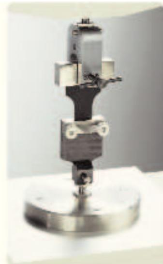
Используется для измерения прочности верхнего или выстилающего материала по линии шва обуви с помощью одного или нескольких отверстий в образце.
