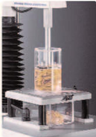
Предназначена для измерения силы сжатия, которую необходимо приложить к поршню для экструзии продукта через выходное отверстие стандартного размера в основании контейнера для образца. Контейнер для образца может вмещать диски с диаметром 3, 5, 7 или 10 мм, их выбор зависит от консистенции образца. Контейнер для образца устанавливается во вставку основной платформы, а диск присоединяется к тензодатчику с помощью переходника для зонда.
