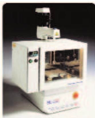
Терmostаты решают проблемы, связанные с исследованием горячих или холодных продуктов, например, расплавленного сыра или мороженого. Возможно, перед исследованием потребуется дождаться выравнивания температуры образца и камеры.
