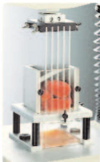
Имеются две версии ячейки Крамера для определения силы сдвига. С тензодатчиком 50 кг или более нужно использовать HDP/KS10 с 10 лезвиями. HDP/KS5 с 5 лезвиями может использоваться с тензодатчиками 25 или 30 кг для мягких продуктов, но рекомендуется тензодатчик 50 кг или более. Быстро съемные переходники позволяют быстро снимать лезвие для очистки или замены.
