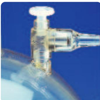
ния первоначального вакуума полезно смазать уплотнительное кольцо тонким слоем масла. Внутри находится емкость для высушивающего агента. Имеется кран для спуска вакуума (односторонний клапан), рифленая пробка позволяет медленно впустить воздух, избегая перемешивания содержимого.
