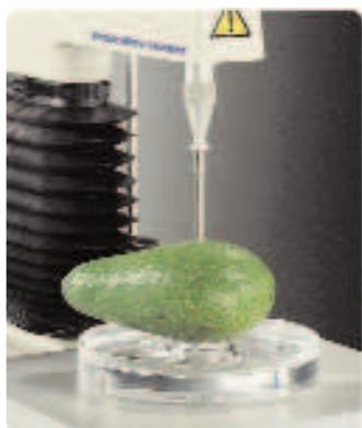
Из-за своей формы многие исследуемые образцы не держатся на поверхности основной платформы анализатора текстуры. Эта круглая подставка предназначена для установки образцов круглой, сферической и неправильной форм.
