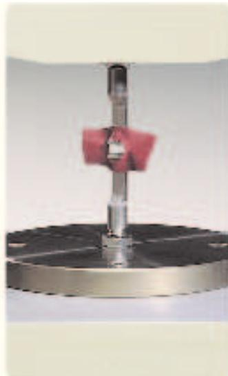
Испытание на силу отрыва лоскута или испытание на отрыв по Бауману в соответствии с IUP 8; измеряет силу, необходимую для отрыва длинного лоскута на постоянной скорости  $100 \pm 20$  мм/мин.
