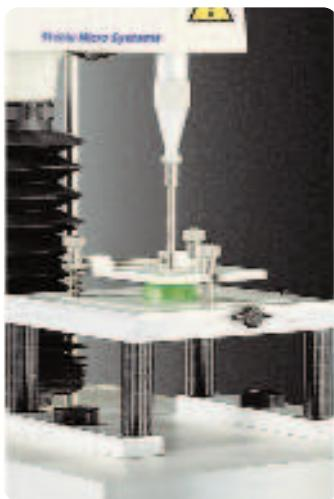
При исследовании слипаемости таких продуктов, как образец кондитерского изделия, их необходимо зафиксировать, в противном случае образец останется на зонде при попытке его извлечения. Держатель состоит из пластины основания, на которой располагается другая пластина, удерживающаяся пружинными зажимами.
