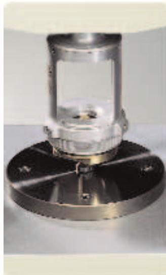
Этот тест известен также как испытание на сопротивление разрыву и определяет прочность и растяжимость лицевой стороны кожи. Он превышает требования стандарта, так как сила надрыва кожи измеряется без остановки теста. Кроме того, определяется устойчивость материала к деформации.
