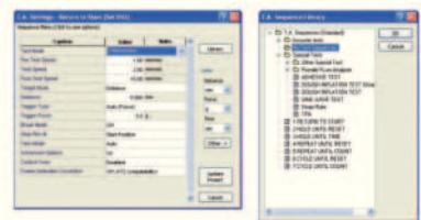
◀ **С: Программирование последовательности действий:** полностью самостоятельное программирование движений кронштейна прибора. Пользователь может ввести свою последовательность действий для задания движений кронштейна, регистрации данных и контроля результатов изменений периферийским оборудованием, например, температурными датчиками.
