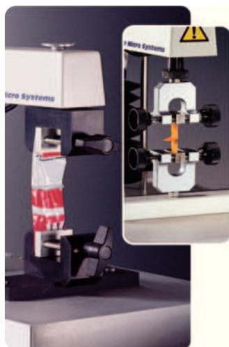
Предлагаемые зажимы позволяют жестко закрепить образец и определить величину, на которую можно вытянуть образец до окончательного разрыва структуры и также определить силу, с которой можно произвести непосредственный разрыв. Два этих показателя характеризуют качество бумаги и картона, из которых можно делать упаковки и т. д.
