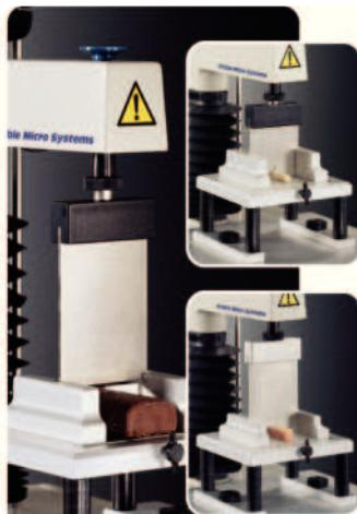
Набор лезвий HDP/BS включает: лезвие Уорнер Братцлер, обратное лезвие, вставка с прорезью для лезвий. Обратное лезвие имеет изогнутый режущий край на одном конце и прямой край («гильотина») на другом.
