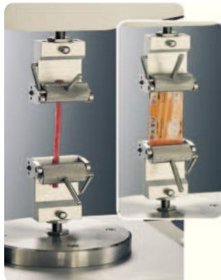
Пружинные ролики с поперечными штрихами образуют самозатягивающийся механизм, удерживающий образцы шириной до 45 мм и длиной до 10 мм.
