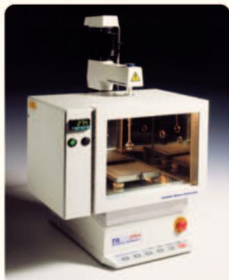
Термостаты решают проблемы, связанные с исследованием горячих или холодных продуктов, например, расплавленного сыра или мороженого. Возможно, перед исследованием потребуется дождаться выравнивания температуры образца и камеры.
