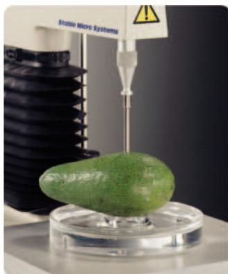
Из-за своей формы многие исследуемые образцы не держатся на поверхности основной платформы анализатора текстуры. Эта круглая подставка предназначена для установки образцов круглой, сферической и неправильной форм.
