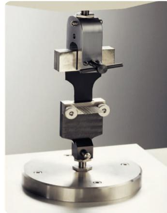
Используется для измерения прочности верхнего или выстилающего материала по линии шва обуви с помощью одного или нескольких отверстий в образце. Насадка A/SLJ1 соответствует требованиям BS 511. Она позволяет прокалывать материал на всю длину 17 иглами, расположенными в ряд, и измерять максимальную силу натяжения при движении иглы в направлении, перпендикулярном ряду. Для определения прочности в направлении, перпендикулярном перфорациям, максимальная сила делится на ширину образца.
