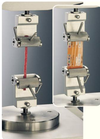
Пружинные ролики с поперечными штрихами образуют самозатягивающийся механизм, удерживающий образцы шириной до 45 мм и длиной до 10 мм.
