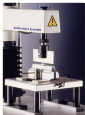
Идеально подходит для исследования образцов малого диаметра, например, таблеток. Зазор в держателе для образцов от 2 мм.
