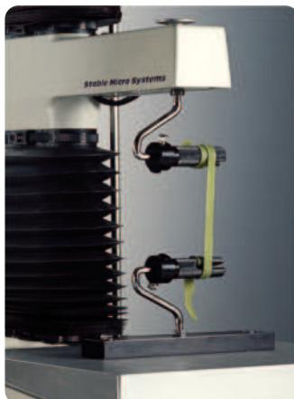
Идеально подходит для измерения прочности на разрыв и эластичности образцов. Образец вставляется через щели в параллельных валиках, и его концы закручиваются на 2-3 оборота для уменьшения скольжения и для закрепления.
