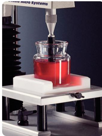
Оценка эластичности, твердости и прочности на разрыв масел и смазок – очень важна как для производителей так и для потребителей.
