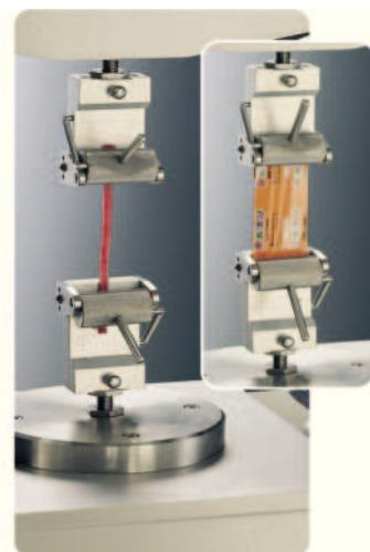
Пружинные ролики с попечерными штрихами образуют самозатягивающийся механизм, удерживающий образцы шириной до 45 мм и длиной до 10 мм. Эти зажимы идеальны для измерения прочности на разрыв и особенностей разрыва разнообразных материалов с гладкой поверхностью или изменяющих свои физические свойства после растяжения.
