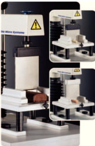
Набор лезвий HDP/BS включает: лезвие Уорнер Братцлер, обратное лезвие, вставка с прорезью для лезвий. Обратное лезвие имеет изогнутый режущий край на одном конце и прямой край («гильотина») на другом.
