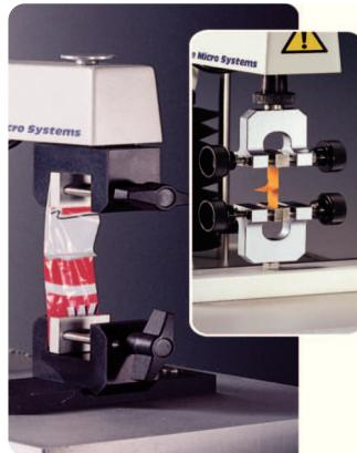
Это зажимы общего назначения, подходящие для удерживания образцов с равномерной прямоугольной формой и максимальной толщиной 25 мм.
