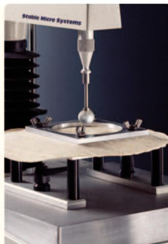
Разработана для измерения растяжимости и эластичности. Кроме того, позволяет быстро и надежно закреплять различные типы тонких или слоистых образцов.
