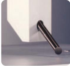
Образец вставляется в насадку и испытывается на твердость и прочность путем сжатия. Результаты исследования позволяют оценить такие переменные процессы как состав образца, а также качество образца после воздействия экстремальных температур.
