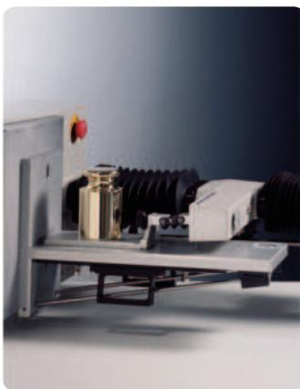
Состоит из несущей и регулируемой по высоте ножек, которые закрепляются на анализаторе текстуры так, чтобы вся конструкция могла располагаться горизонтально. Платформа прикрепляется к основанию, на котором размещается образец, по которому скользит полоз, соединенный с тензодатчиком.
