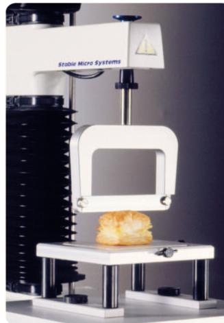
Это устройство включает сменное лезвие толщиной 0,9 мм, вставляющееся в раму шириной 115 мм. Оно было введено в связи с популярностью стандартного ножа для резьбы и необходимостью в тонком ноже для резки более толстых и широких фрагментов. Максимальная ширина образца 100 мм.
