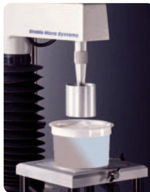
**P/36R – Цилиндрический пресс-зонд** – может использоваться для проведения обратной экструзии для майонезов, муссов, определения консистенции.
