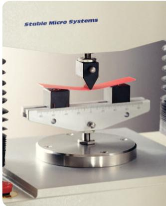
Исследуемый образец прямоугольного или круглого сечения укладывается на две опоры с известным расстоянием между ними. Затем на точку, равноудаленную от обеих опор, воздействует изгибающая сила на постоянной скорости, либо до определенного значения силы, либо до разлома образца.
