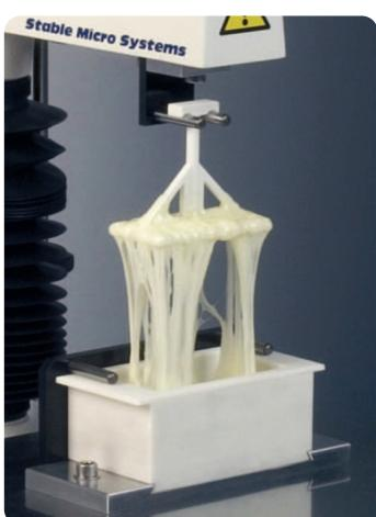
Состоит из сосуда для микроволновой обработки и двухстороннего вильчатого зонда. В систему с сосудом и вилкой помещают образец известной массы и обрабатывают микроволновым излучением до расплавления.
