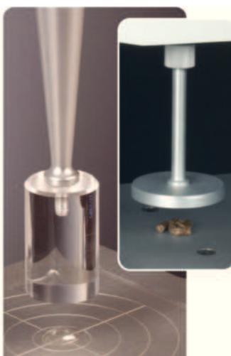
Используются для испытаний продуктов, держащих форму, например, гранул, таблеток и упаковки. Для прямого испытания на сжатие необходимо, чтобы образец был меньше компрессионной пластины; при этом измеряется сжатие/восстановление формы, характер сжатия. Это позволяет также определять косвенные показатели, например, упругость.
