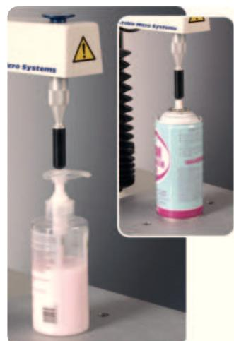
Сила срабатывания аэрозоля.
