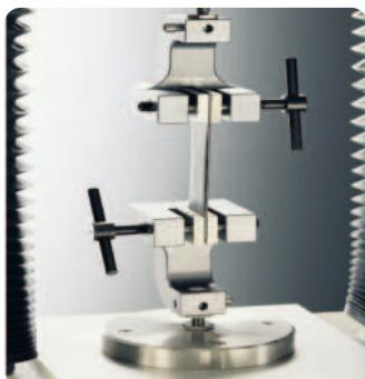
А/HDT – зажимы для испытания растяжимости с максимальной нагрузкой 500 кг (5 кН). Поверхности зажима имеют ширину 50 и высоту 30 мм; они рифленые. По специальному заказу возможна поставка зажимов с другой поверхностью.
