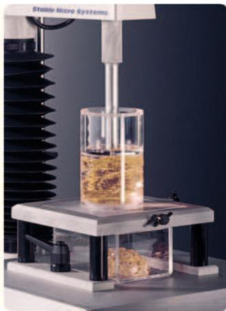
Предназначена для измерения силы сжатия, которую необходимо приложить к поршню для экструзии продукта через выходное отверстие стандартного размера в основании контейнера для образца. Контейнер для образца может вмещать диски с диаметром 3, 5, 7 или 10 мм, их выбор зависит от консистенции образца. Контейнер для образца устанавливается во вставку основной платформы, а диск присоединяется к тензодатчику с помощью переходника для зонда.
