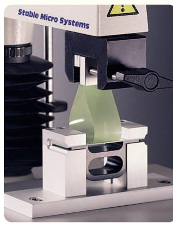
Этот метод разработан для оценки, вероятно, самого важного и самого сложного для измерения качества материалов, чувствительных к давлению – силы сцепления.
