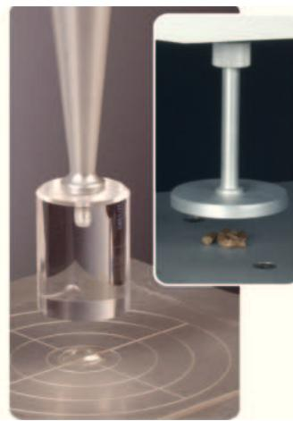
Используются для испытаний продуктов, держащих форму. Для прямого испытания на сжатие необходимо, чтобы образец был меньше компрессионной пластины; при этом измеряется сжатие/восстановление формы, характер сжатия и вязкость/эластичность. Это позволяет также определять косвенные показатели, например, упругость и свежесть.
