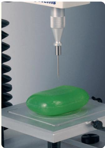
Игольный зонд используется для исследования качества и структуры поверхностного слоя упругих изделий, а именно – определения силы прокалывания поверхности (или динамического сопротивления), и прочности на прокол. Используются вместе с алюминиевыми переходниками для закрепления зонда в анализатор текстуры. В стандартный комплект поставки входит один переходник AD/100.
