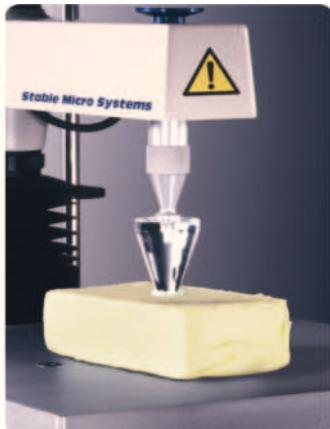
Мы предлагаем четыре вида зондов из перспекса с углами от 30° до 60° для испытания с погружением конуса в продукты с пластическими свойствами. Конусная пенетрометрия хорошо коррелирует с органолептической оценкой и результатами определения растекаемости.
