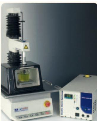
Термостат с элементами Пельтье позволяет работать при температуре от  $80^{\circ}\text{C}$  до температуры, на  $30^{\circ}\text{C}$  ниже окружающей; ПИД-контроль.
