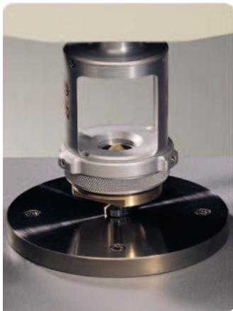
Этот тест известен также как испытание на сопротивление разрыву и определяет прочность и растяжимость лицевой стороны кожи. Он превышает требования стандарта, так как сила надрыва кожи измеряется без остановки теста. Кроме того, определяется устойчивость материала к деформации.
