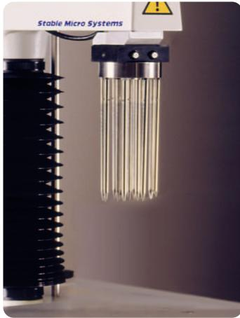
Предназначен для определения прочности и твердости таких продуктов, как консистенческие смазки. Применение многоигольного зонда, прокалывающего образец в нескольких местах, создает эффект усреднения и, следовательно, способствует лучшей воспроизведимости результатов.
