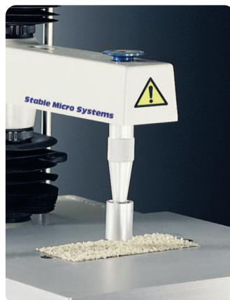
Семейство зондов с уплощенным концом диаметром от 2 до 50 мм подходит для исследования самых разнообразных образцов.
