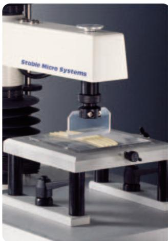
Небольшое лезвие из перспекса, располагающееся непосредственно на тензодатчике, используется для исследования образцов малого размера, для разламывания или разрезания которых не требуется большого усилия.
