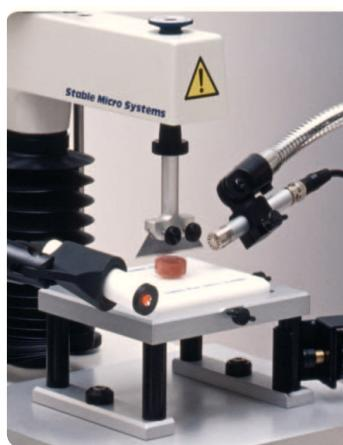
Позволяет измерять высвобождение звуковой энергии во время физического испытания. Измеряется испускание звуковых волн в диапазоне до 12 кГц и переводится в аналоговое напряжение, которое соответствует количеству высвобожденной звуковой энергии из продукта как функции времени.
