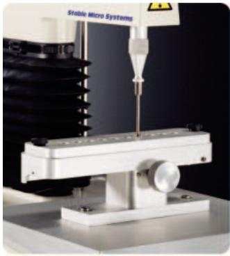
Позволяет исследовать 10 клейких лент одновременно с помощью сферического зонда.
