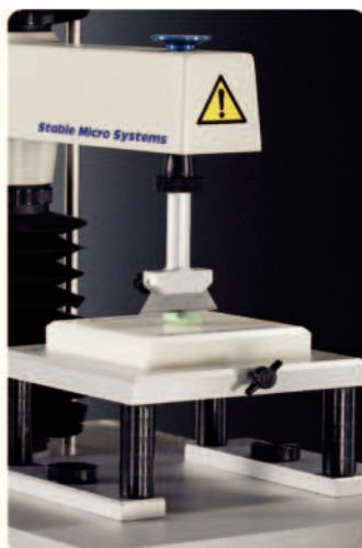
Включает стандартное заменяемое лезвие шириной 50 мм, позволяющее точно разрезать образцы. Острое лезвие может резать твердые продукты; есть также вариант «сменного» лезвия, если оно затупилось.
