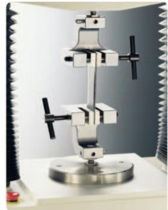
A/HDT – зажимы для испытания растяжимости с максимальной нагрузкой 500 кг (5 кН). Поверхности зажима имеют ширину 50 и высоту 30 мм; они рифленые. По специальному заказу возможна поставка зажимов с другой поверхностью. Зажимы могут удерживать образцы максимальной шириной до 12 мм.
