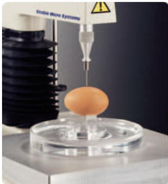
Устойчивая подставка для яиц при испытании прочности на прокол/раздавливание, задерживает разлившееся содержимое.
