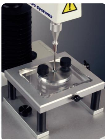
Это устройство позволяет измерять прочность на разрыв продуктов, например: синтетической кожи.
