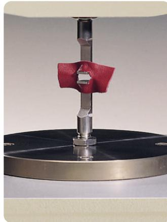
Испытание на силу отрыва лоскута или испытание на отрыв по Бауману в соответствии с IUP 8; измеряет силу, необходимую для отрыва длинного лоскута на постоянной скорости  $100 \pm 20$  мм/мин.
