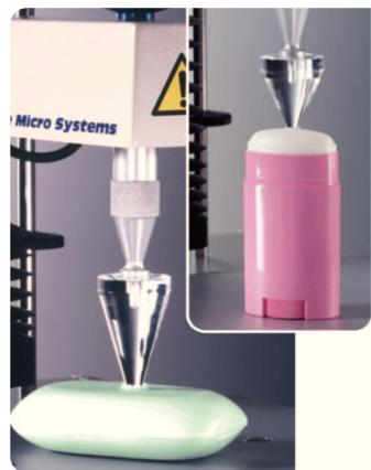
Эта насадка позволяет анализировать трение разнообразных материалов при смазывании их различными видами масел и смазок.
