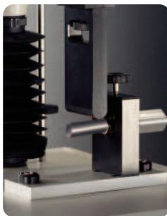
Образец вставляется в насадку и испытывается на разлом, изгиб, крошение и растрескивание. Это испытание проводится с помощью полусферического лезвия, имитирующего реальную изгибающую силу во время использования образца.
