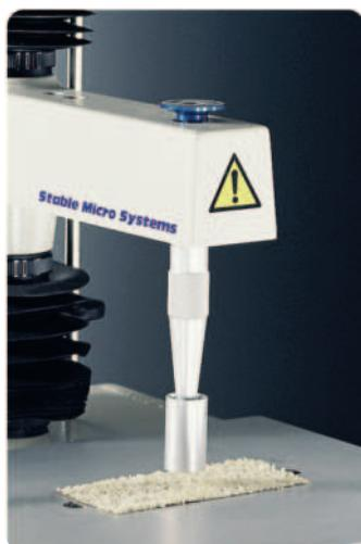
Семейство зондов с уплощенными концами диаметром от 2 до 50 мм подходит для исследования самых разнообразных образцов. Цилиндрические зонды используются при определении твердости, прочности или предела текучести. При испытании на прокол измеряются как сдавливающие, так и сдвигающие силы. Кроме того, можно определять такие свойства, как точка разрыва и адгезивные характеристики поверхности.
