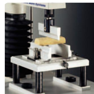
Большая часть состоит из основания с градуированной опорой регулируемой длины (до 240 мм) и позволяет исследовать образцы шириной до 90 мм. Меньшая часть с тремя точками перегиба представляет собой опору регулируемой длины до 70 мм и вмещает образцы шириной до 80 мм.
