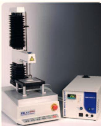
Обеспечивает поверхность со стабильной температурой для исследования тонких образцов, например, самоклеящихся этикеток. Это гарантирует минимальное влияние температуры на результаты или точную его оценку.
