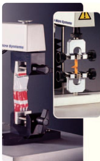
Зажимы A/TG закрепляются винтом, при закручивании которого сдвигаются их рифленые бранши. Это зажимы общего назначения, подходящие для удерживания образцов с равномерной прямоугольной формой и максимальной толщиной 25 мм.
