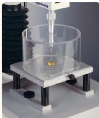
Из высокопрочного листа перспекса; обеспечивает высокую степень защиты при испытаниях с разрушением; недорог, подходит для любых анализаторов текстуры.
