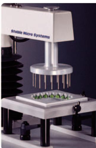
Позволяет измерять силу проникновения зонда в несколько (до 18) образцов одновременно. Вставка имеет 18 углублений, расположенных вокруг конуса, что позволяет легко расположить образцы в необходимых для испытания положениях. Затем измеряется сила прокола и проникновения, а глубина проникновения устанавливается так, чтобы зонды прокололи образец на всю его толщину.
