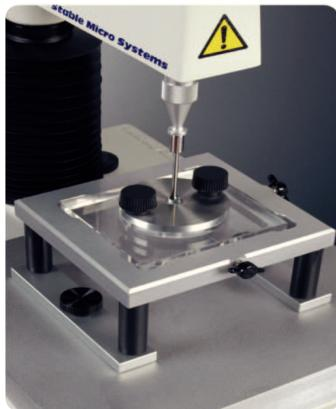
Это устройство позволяет измерять прочность на разрыв тонких изделий в форме пленок. Насадки с держателем для пленки позволяют выявить пониженную прочность и соответствующим образом скорректировать состав.
