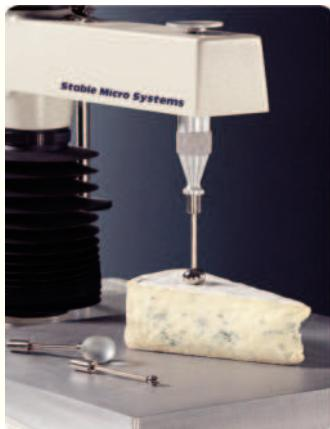
Мы предлагаем сферические (шарообразные) зонды диаметром 0.25"-1.0" (6.25-25.4 мм) и один тип полусферических зондов. Их можно использовать для определения твердости поверхности методом вдавливания; часто этот метод предпочтительнее испытания на прокол, особенно если у образца неровная поверхность.
