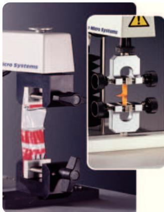
Зажимы A/TG закрепляются винтом, при закручивании которого сдвигаются их рифленые бранши. Это зажимы общего назначения, подходящие для удерживания образцов с равномерной прямоугольной формой и максимальной толщиной 25 мм.
