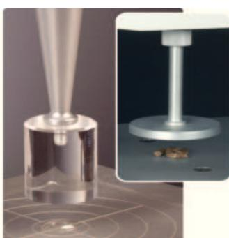
Используются для испытаний продуктов, держащих форму. Для прямого испытания на сжатие необходимо, чтобы образец был меньше компрессионной пластины; при этом измеряется сжатие/восстановление формы, характер сжатия и вязкость/эластичность. Это позволяет также определять косвенные показатели, например, упругость.
