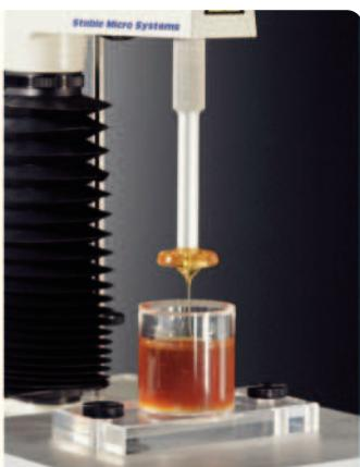
Включает контейнер для образца, расположенный под поршнем. Поршень сдавливает образец, который выталкивается вверх вдоль краев диска.
