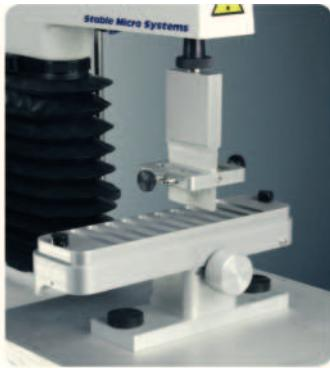
Включает пластину с несколькими щелями и зажим; предназначен для измерения силы адгезии, например, материала поверхности и клейкой ленты.
