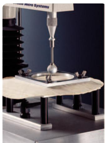
Разработана для измерения растяжимости и эластичности. Кроме того, позволяет быстро и надежно закреплять различные типы тонких или слоистых образцов.
