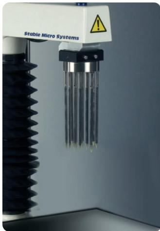
Позволяет определять плотность и твердость продуктов.
