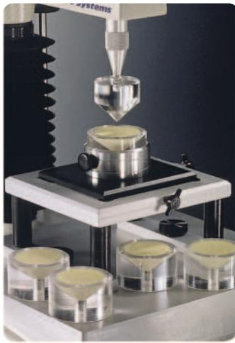
Предназначена для измерения способности продукта, например, воска, распределяться тонким равномерным слоем. Она состоит из конуса с углом 90° с охватывающим соединением и пяти точно соответствующих ему держателей конической формы с охватывающим соединением.
