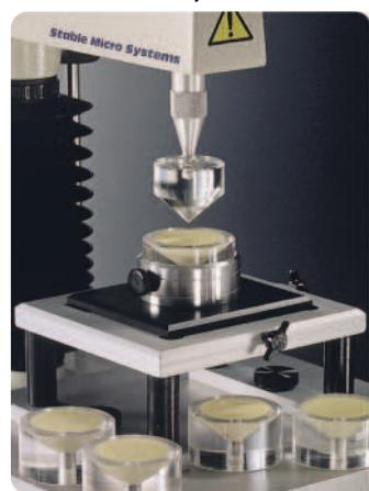
Предназначена для измерения способности продукта распределяться тонким равномерным слоем. Она состоит из конуса 90° с охватываемым соединением и пяти точно соответствующими ему держателями конической формы с охватываемым соединением.
