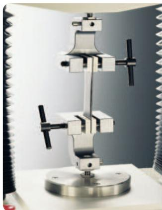
A/HDT – зажимы для испытания растяжимости с максимальной нагрузкой 500 кг (5 кН). Поверхности зажима имеют ширину 50 и высоту 30 мм; они рифленые.
