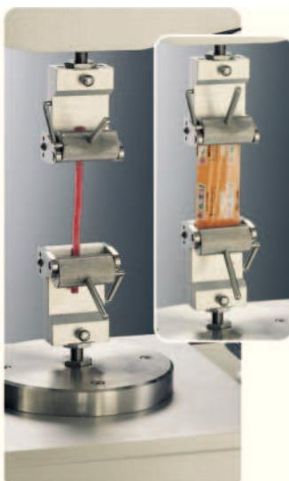
Пружинные ролики с попечными штрихами образуют самозатягивающийся механизм, удерживающий образцы шириной до 45 мм и длиной до 10 мм. Эти зажимы идеальны для измерения прочности на разрыв и особенностей разрыва разнообразных материалов с гладкой поверхностью или изменяющих свои физические свойства после растяжения.
