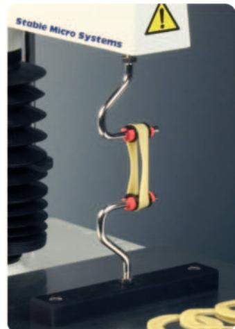
Включает: уникальный кольцевой нож для образца, ручной пресс и шайбы для закрепления образца, подходящие к насадке для измерения растяжимости и прочности на разрыв резиновых колец и резиновых пассиков.
