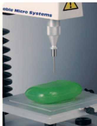
Игольный зонд используется для исследования поверхности образца или динамического сопротивления, а также прочности или испытания восков на прокол.
