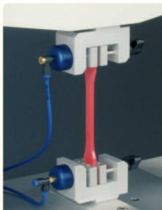
A/HDG – зажимы для испытания растяжимости с максимальной нагрузкой 100 кг (1 кН). Их зажимные поверхности имеют ширину и высоту 30 мм.
