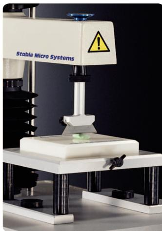
Включает стандартное заменяемое лезвие шириной 50 мм, позволяющее точно разрезать образцы. Острое лезвие может резать твердые продукты; есть также вариант «сменного» лезвия, если оно затупилось.
