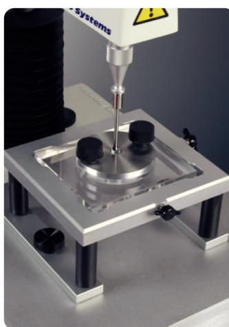
Это устройство позволяет измерять прочность на разрыв. Насадка с держателем позволяет выявить пониженную прочность и соответствующим образом скорректировать состав.
