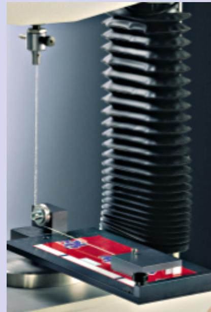
Используется для определения статического и динамического коэффициента трения. Соответствует требованиям ASTM D 1894-90. Может использоваться для определения характеристик трения материалов, скользящих по таким же или другим материалам в соответствующих условиях испытания.
