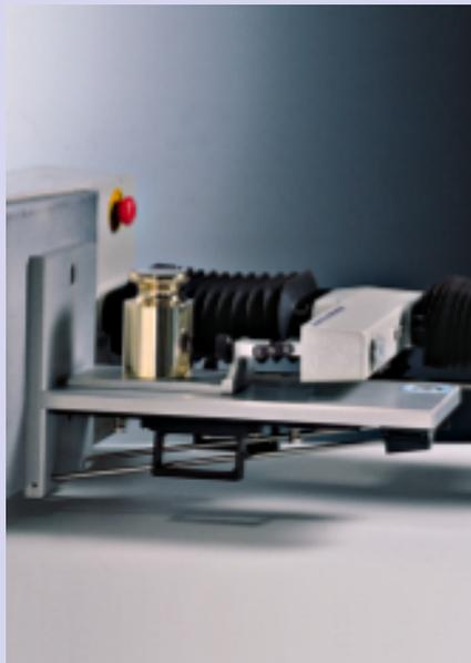
Состоит из несущей и регулируемой по высоте ножек, которые закрепляются на анализаторе текстуры так, чтобы вся конструкция могла располагаться горизонтально.
