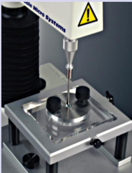
Это устройство позволяет измерять прочность на разрыв тонких изделий. Насадка с держателем для пленок позволяет выявить пониженную прочность.
