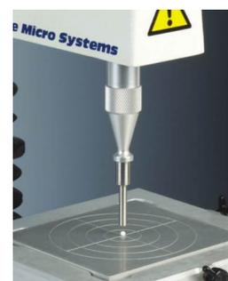
Измерение механической прочности одной частицы.
