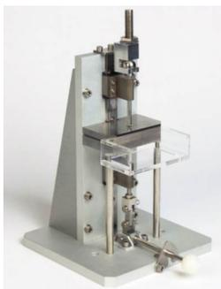
Насадка с большим зазором подходит для методик, требующих приложения значительной силы, когда размеры штампа /пробойника критичны.
