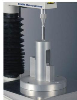
Насадка с маленьким зазором подходит для разных типов исследований со сжатием порошков, например, оценки ломкости гранул, где размеры штампа/пробойника менее критичны.
