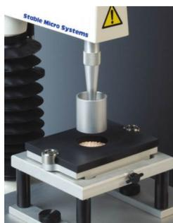
Оценивает твердость/сжимаемость гранул.
