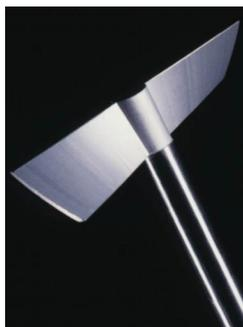
Это точный и достоверный способ измерения характеристик сыпучести порошков. Во время испытания датчиком измеряется максимальная сила, время и расстояние, а данные отображаются и анализируются в реальном времени с помощью программы Exponent.
